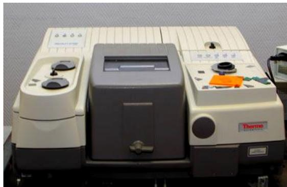
**Fig. 1.** FTIR-spectrophotometer «Nexus»
