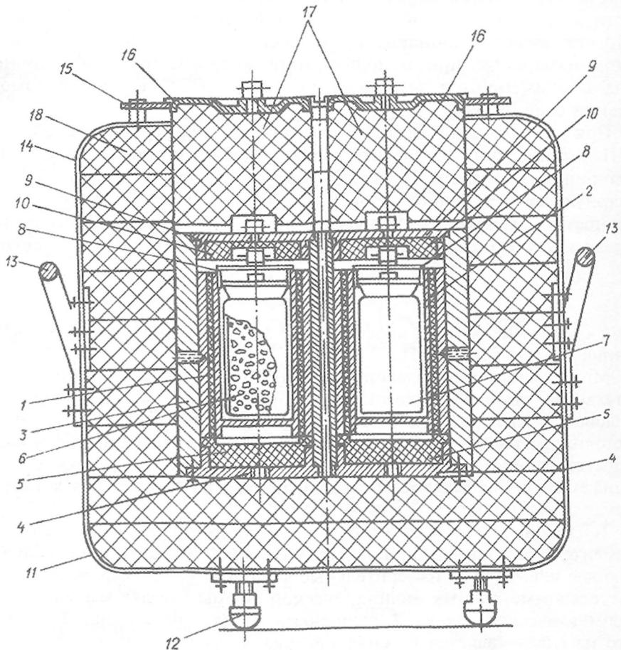
Рис. 3. Конструктивная схема теплового блока микрокалориметра
