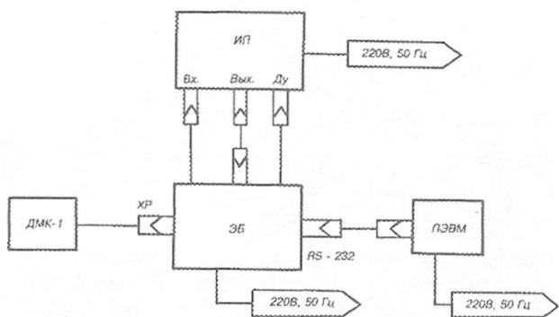
Рис. 2. Структурная схема микрокалориметра:
