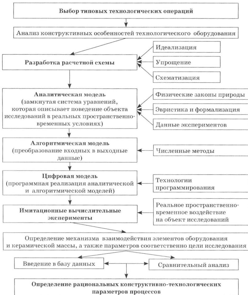
*Рис. 1. Схема информационной технологии проектирования*
