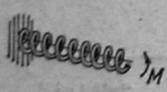
Винтовая пружина при кручении:
