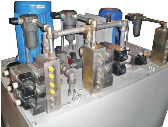
Рис. 5. Общий вид объемного гидрпривода с устройствами управления
