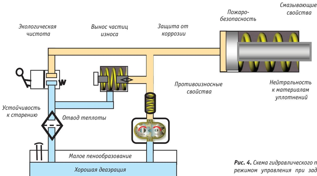
**Рис. 4.** Схема гидравлического привода с ручным режимом управления при заданных условиях эксплуатации
