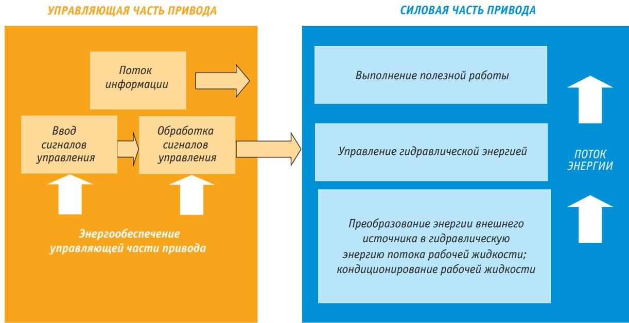
Рис. 3. Структура пневмопривода
