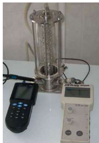
Рис. 3 Лабораторний ферментер для вирощування клітин рослин
