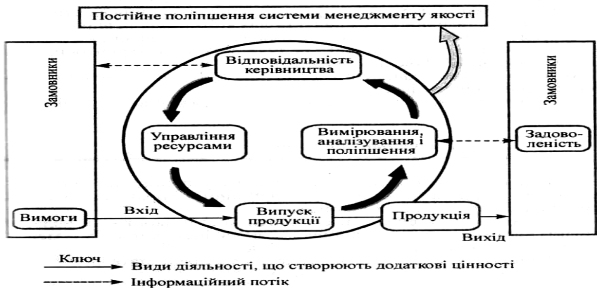
Рис. 3. Модель системи управління якістю, що базується на процесному підході [5]
