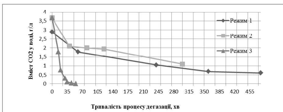
Рис. 1. Зміна вмісту CO 2 у мінеральній воді в процесі її дегазації
