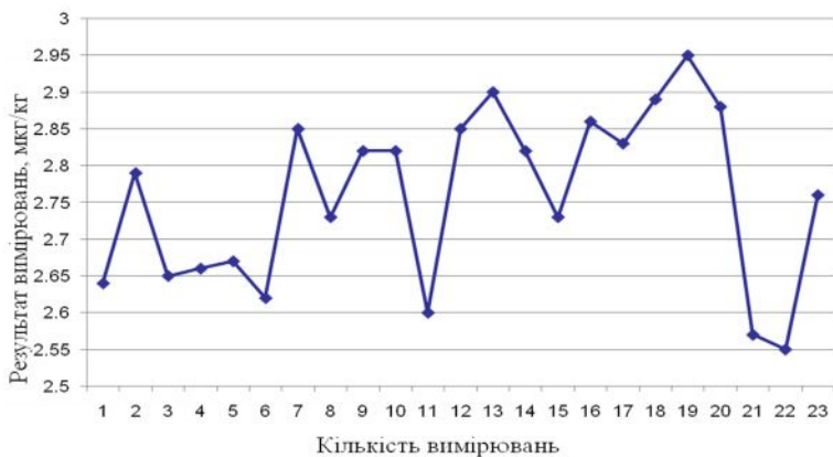
Рисунок 4 – Результати досліджень контрольного зразка олії соняшникової за допомогою аналізатора Agilent 1200
