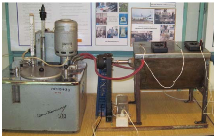
Рис.1. Экспериментальная установка для дослідження процесу кристалізації сахарози охолодженням
