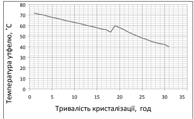
Рис.7. Зміна температури утфелю останнього ступеня кристалізації
