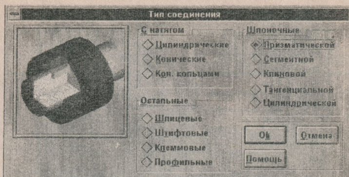
Рис. 4.23 Діалогове вікно вибору типу з'єднання Вал-Маточина
