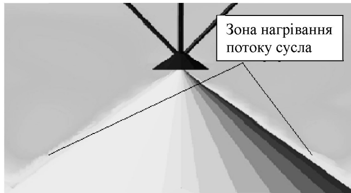
Рисунок 1 – Схема розподілення потоку сусла і температури при використанні системи тонко-плівкового кип'ятіння
