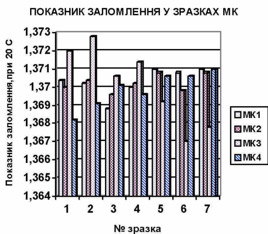
Рис. 1. Порівняльний аналіз зразків екстрактів (зміна колірності, вмісту СР та показників заломлення) при 7-стадійній екстракції ФК
