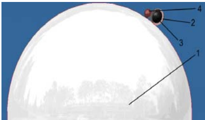
Рис. 2. 3D-модель теплообміну між паровою бульбашкою, що одночасно контактує з більшою і меншою комірками міжкристального розчину сахарози (1-парова бульбашка; 2-міжкристальний розчин сахарози меншої комірки; 3-кристал сахарози; 4- міжкристальний розчин сахарози більшої комірки)
