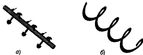
Рис. 2. Геометричні моделі перемішуючих органів: а) — вал з лопатками; б) — спіраль
