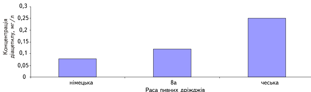
Рис. 2. Вміст діацетилу в готовому пиві в залежності від використаної раси дріжджів
