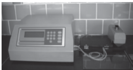
Рис. 2. Загальний вигляд лабораторної установки Messmer Buchel K513 для визначення повітропроникності повітря через пористі матеріали
