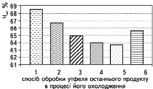
Рис. 3. Залежність чистоти міжкристального розчину від способу обробки утфелю останньої кристалізації в кінці політермічної кристалізації: 1 — розкачка водою, 2 — розкачка мелясою, 3 — проміжний нагрів на 5 °С, 4 — проміжний нагрів на 7 °С, 5 — проміжний нагрів на 10 °С, 6 — проміжний нагрів на 12 °С
