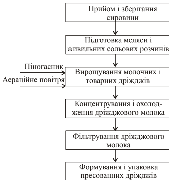
Рис. 1. Схема виробництва пресованих дріжджів
