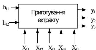
Рис. 1 Підсистема приготування екстракту
