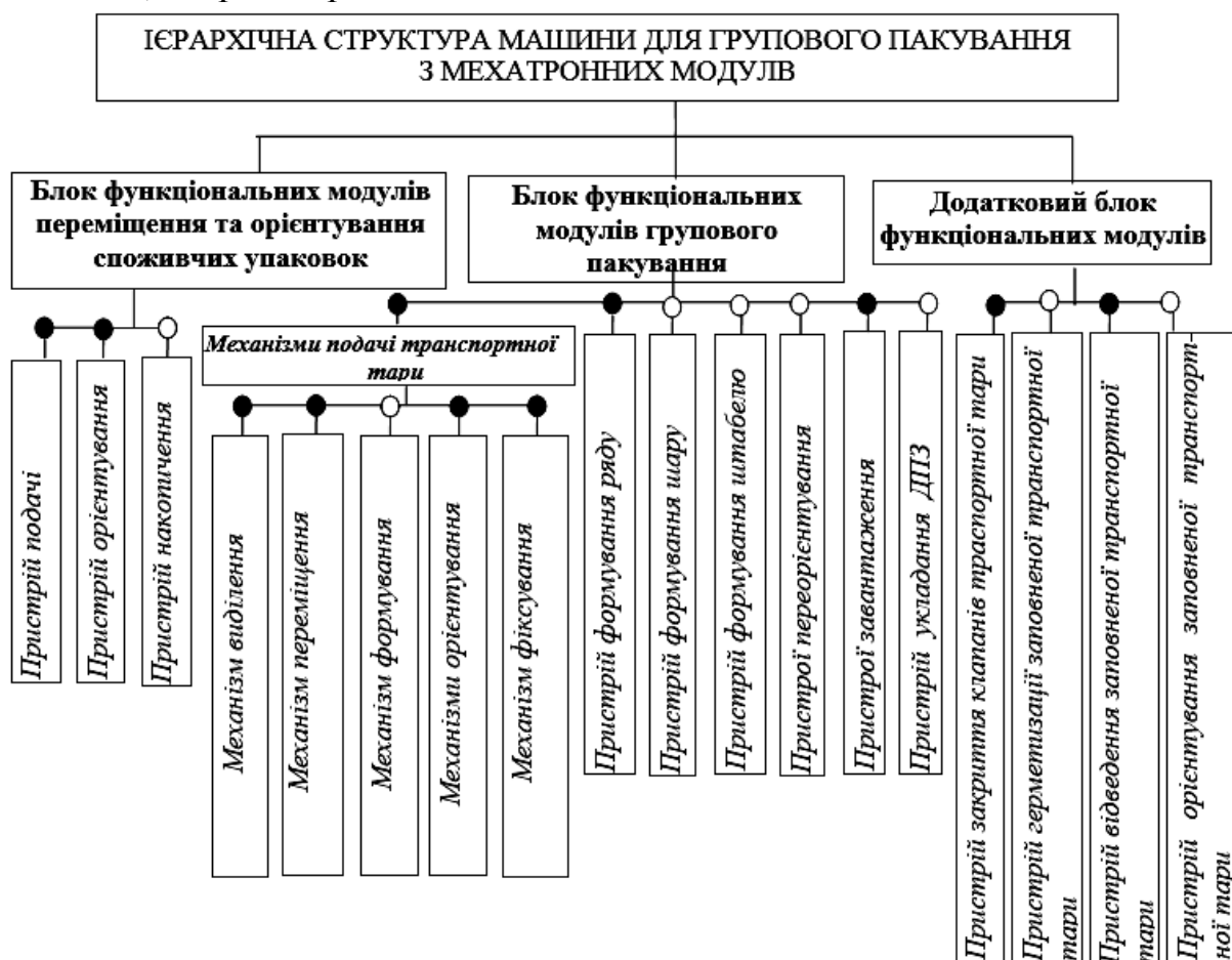
Рис. 4. Узагальнений граф компоновки структури машини для групового пакування з мехатронних модулів: ● — вершини зв'язані «і»; ○ — вершини зв'язані «або».
