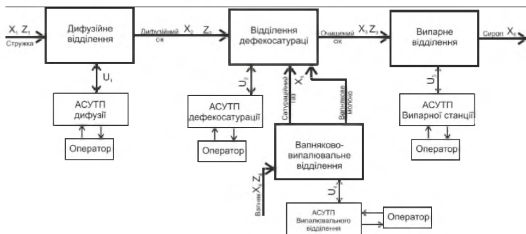
Рис. 1 Структурна схема керування а також матеріальні потоки станції дефекосатурації і суміжних ділянок
