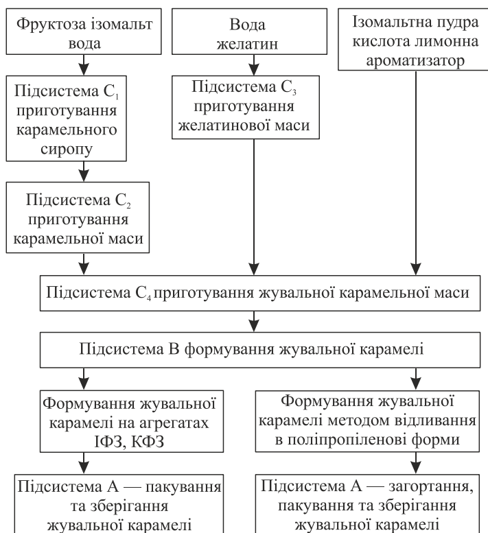
Рис. 1. Виробництво жувальної карамелі дієтично-функціонального призначення (велика технологічна система)
