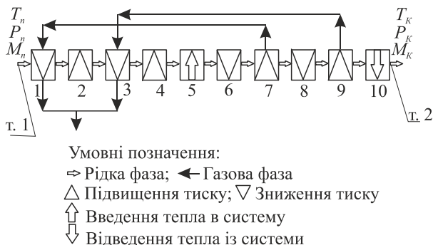
Рис. 1. Послідовність перебігу термодинамічних процесів при ТВО рідини: 1, 3 — процес конденсації; 2, 4, 7, 9 — насос відцентровий; 5 — процес нагрівання; 6, 8 — процес випаровування; 10 — процес охолодження; (точки відбору зразків позначено т.1 і т.2.)
