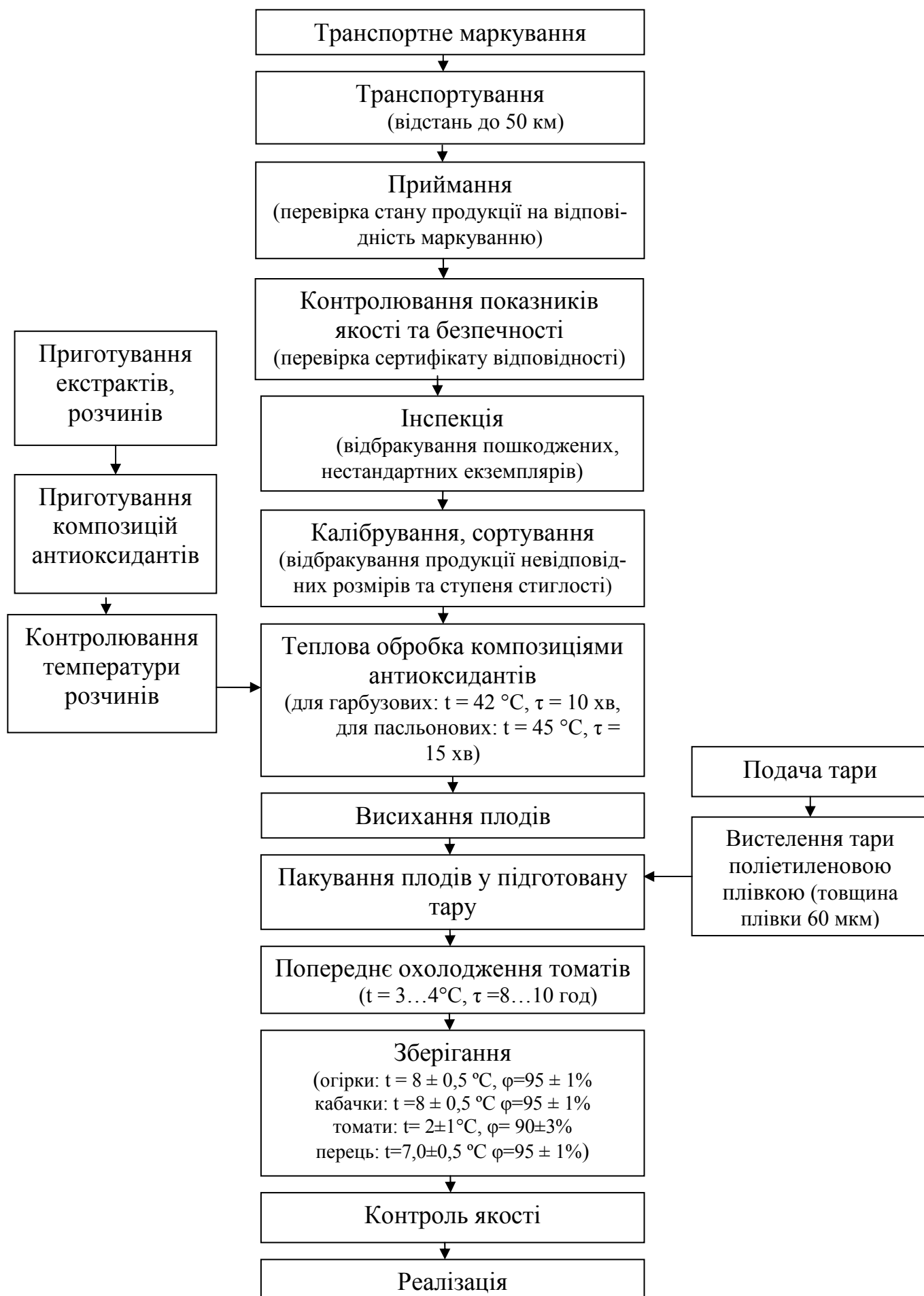
Рис. 13. Функціонально-технологічна схема зберігання плодівих овочів з тепловою обробкою композиціями антиоксидантів
