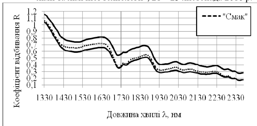
Рис. 1. Інфрачервоні спектри дифузного відбивання високолеїнового необрушеного насіння соняшнику
