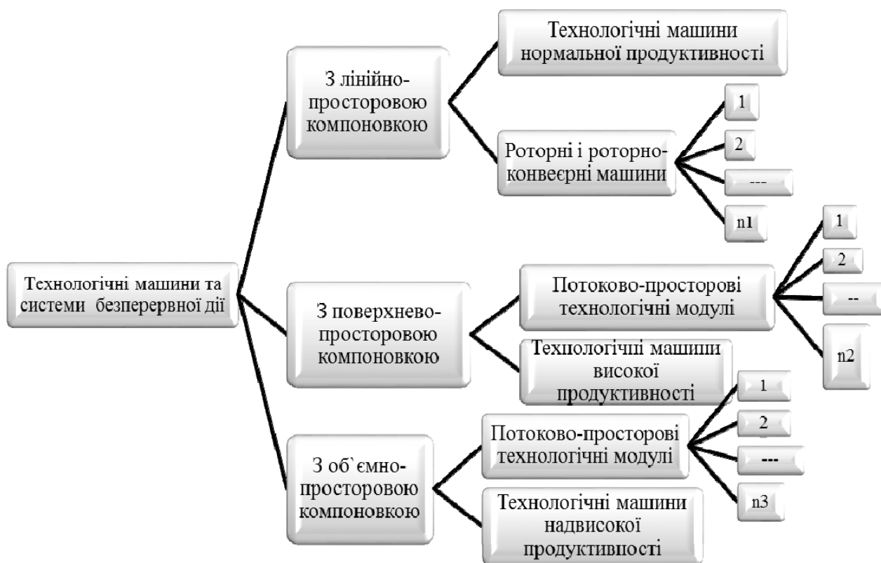
Рис. 1. Структура технологічних машин та систем безперервної дії: 1, 2, n – функціональні технологічні модулі
