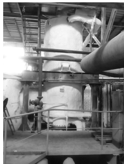
Рис. 4. Вид виготовленого і змонтованого підігрівника дифузійного соку ПДСУ-1800, що обігрівається вторинною парою вакуум-апаратів I кристалізації
