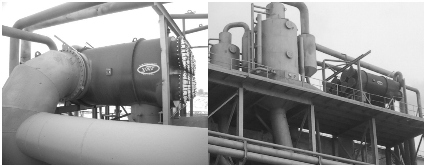
Рис. 3. Вид змонтованих підігрівників дифузійного соку ПДСУ-2000, що обігрівається вторинною парою вакуум-апаратів I кристалізації
