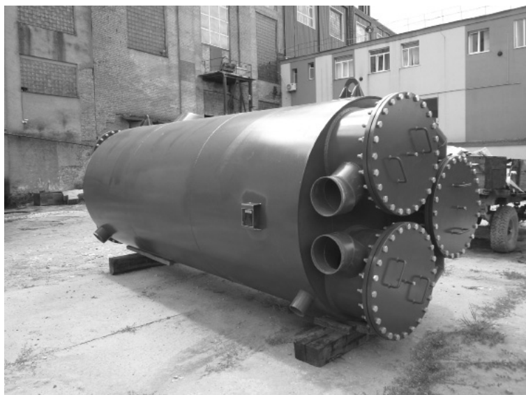
Рис. 4. Вид виготовленого і змонтованого підігрівника дифузійного соку ПДСУ-1800, що обігрівається вторинною парою вакуум-апаратів I кристалізації
