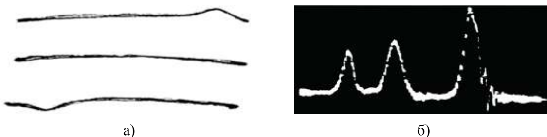
а – \text{H}_2\text{O} [8]; б – \text{C}_2\text{H}_5\text{OH} [7] – (слева направо) протоны гидроксильной (OH), метиленовой ( \text{CH}_2 ) и метильной ( \text{CH}_3 ) групп
