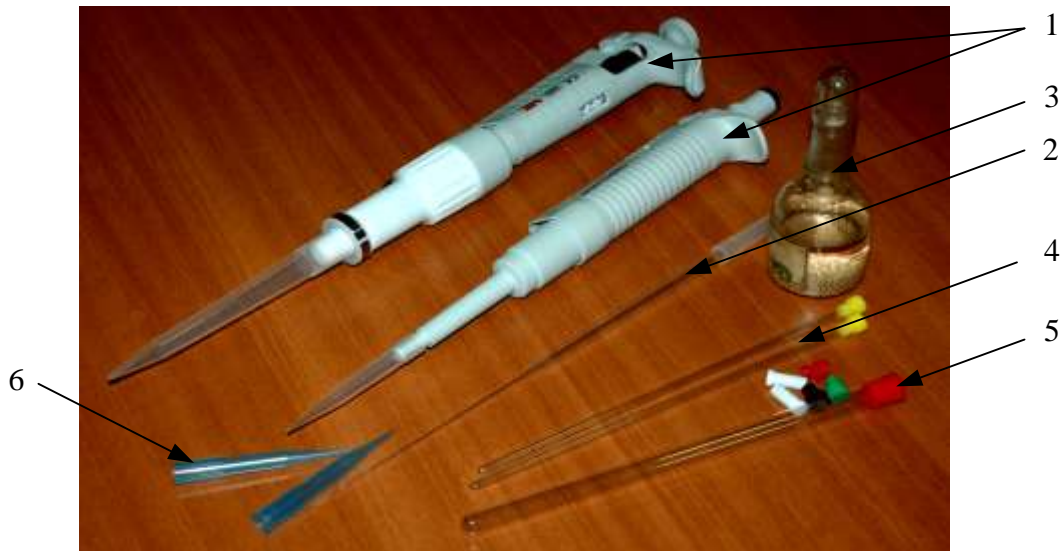
1 – дозаторы; 2 – мерная пипетка; 3 – колба с дейтерорастворителем; 4 – ампулы 5 мм; 5 – ампула 10 мм; 6 – колпачки
