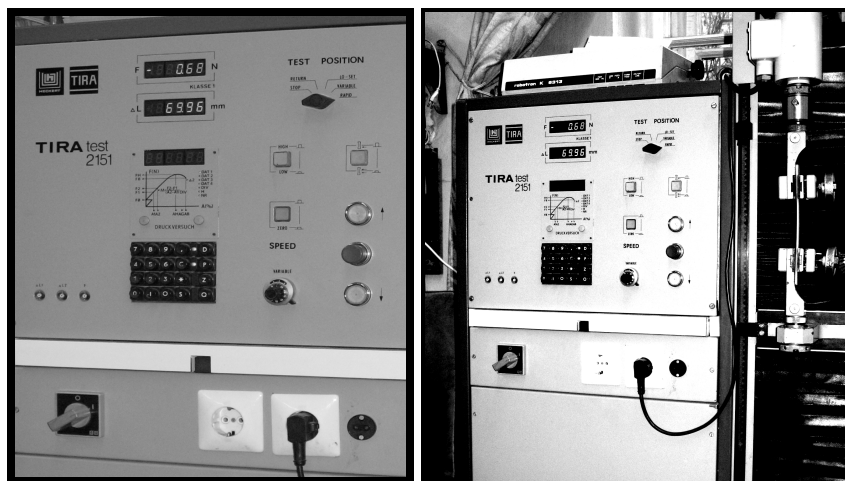
Рис. 1. Випробувальна машина TIRAtest-2151 та її пульт керування (праворуч)
