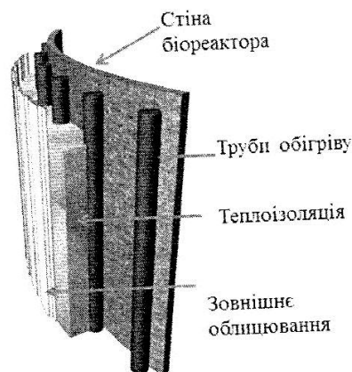
Рис. 1. Вмонтований в стінку біореактора водяний обігрів.
