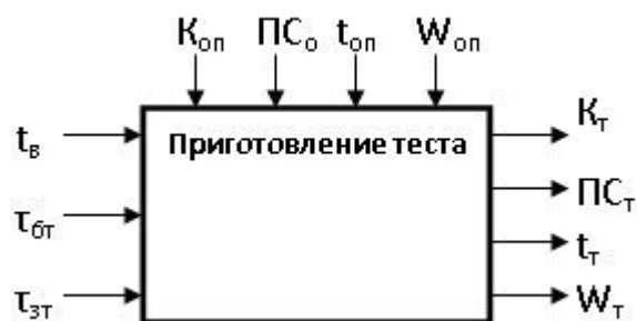
Рис.2. Параметрическая схема процесса приготовления теста
