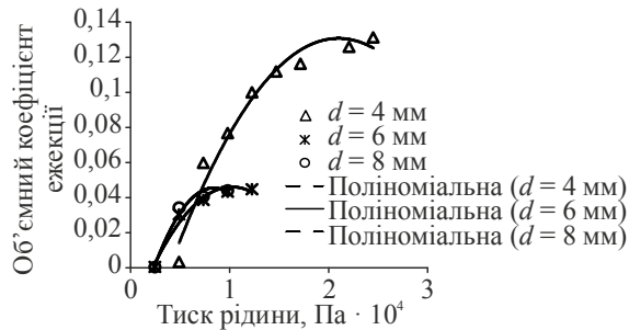
Рис. 8. Залежність коефіцієнта ежекції від тиску на відцентрово-струминній форсунці
