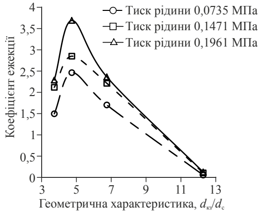
Рис. 10. Залежність об'ємного коефіцієнта ежекції від відношення d_{кз}/d_c : тиск рідини (0,735, 1,47 \text{ і } 1,96) \cdot 10^5 Па
