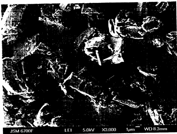
Рис. 3. Сканирующие электронные микрофотографии комплексов бета-циклодекстринов с йодом ( \beta -ЦД-И 2 )
