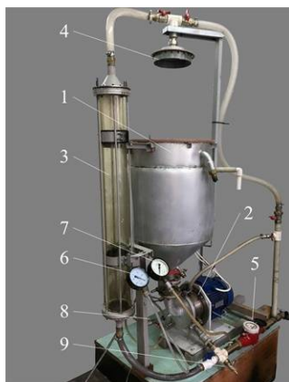
Рис. 1. Аераційно-окиснювальна установка роторного типу (АОРТ): 1 — збірник-накопичувач; 2 — аератор-окиснювач; 3 — фільтраційно-окиснювальна колона; 4 — розпилювальний пристрій; 5 — лічильник води; 6 — манометр; 7 — вакуумметр; 8 — кран подачі повітря; 9 — двоходовий кран
