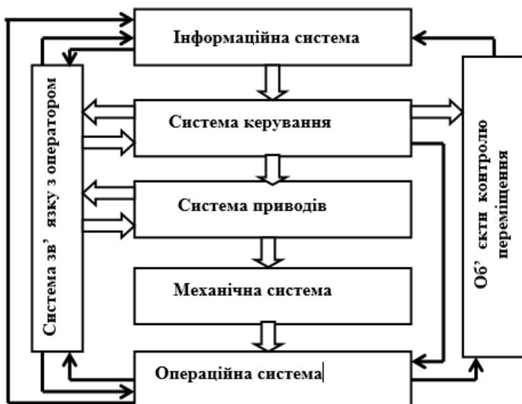
Рис. 1. Типова структурна схема роботизованого комплексу пакування
