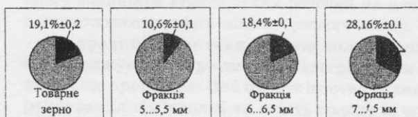
Рис. 2. Залежність травмування зерна від розміру фракції
