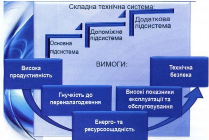
Рис. 2. Структурна схема пакувальної машини та вимоги до її функціонування
