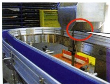
Рис. 8. Вимірювання рівня рідини в ПЕТ-пляшці та перевірка якості закручування кришки за допомогою системи технічного зору компанії Festo
