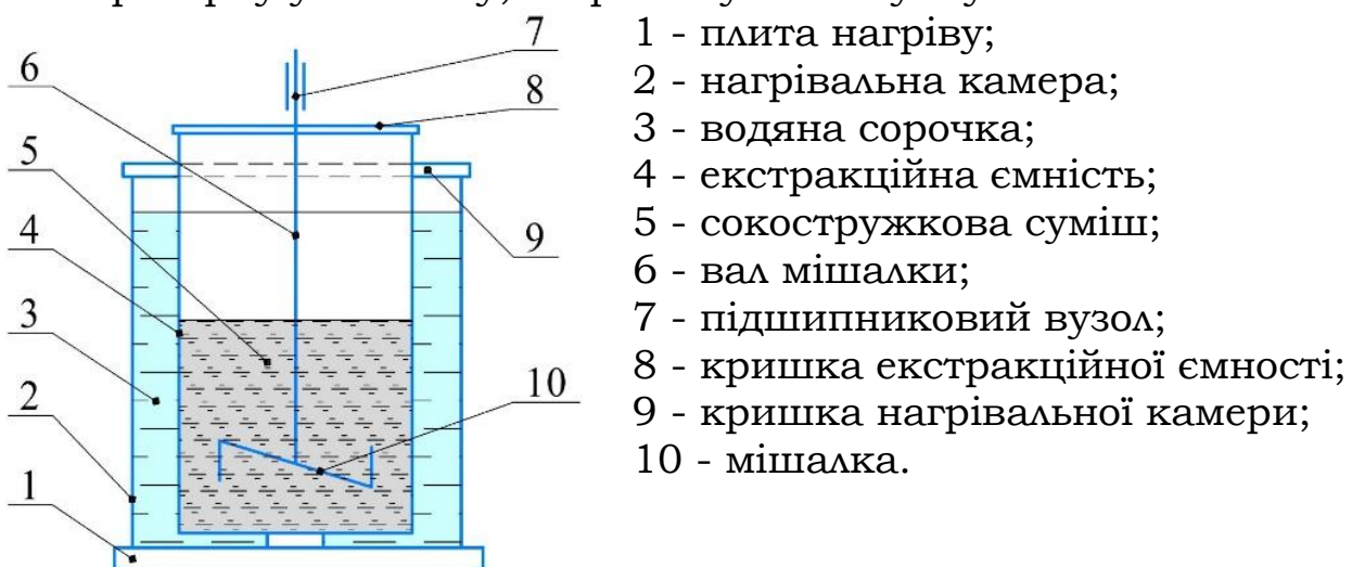
Рис. 1. Лабораторна установка для проведення процесу екстрагування сахарози з бурякової стружки
