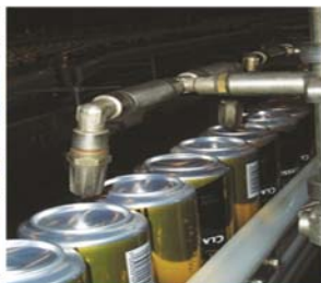
Рис. 1. Приклади використання ежекторів у функціональних соплових пристроях пакувальних машин
