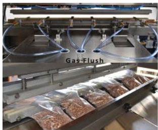
Рис. 1. Приклади використання ежекторів у функціональних соплових пристроях пакувальних машин
