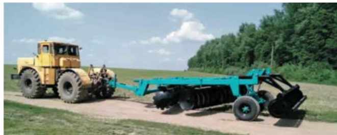
Рис. 4 - Загальний вигляд диско-чизельного агрегата БДВП 4,2-01 з одночасним внесенням рідких добрив
