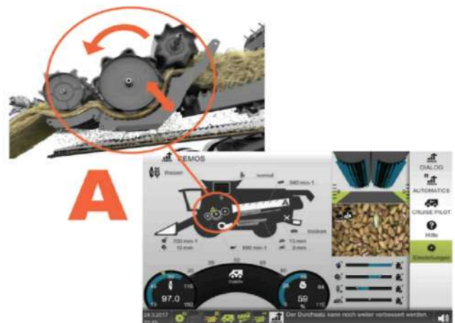
Рис. 2 – Система Cemos Auto Threshing фірми «Claas» (Німеччина)
