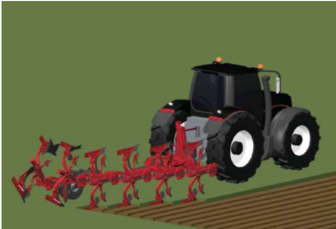
Рис. 5 – Система GPS-based and automated body-lift-out фірми «Kuhn» для автоматизації процесу оранки
