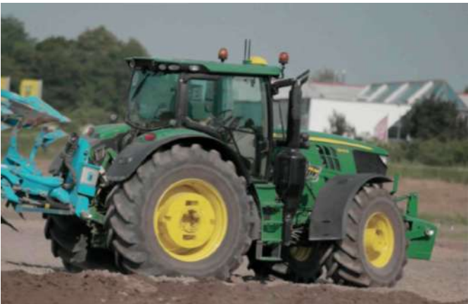
Рис. 3 – Система баластування Ez Ballast Wheels фірми "John Deere"
