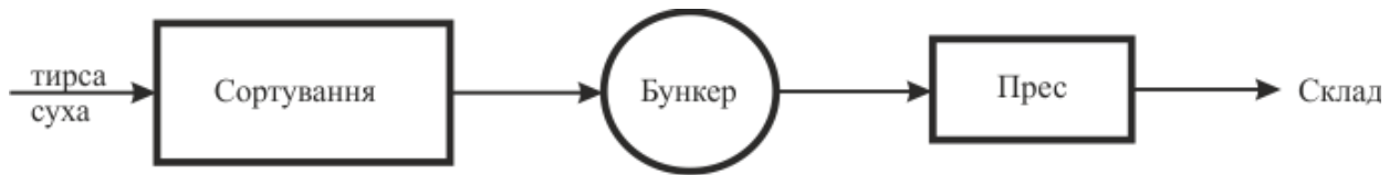
Рис. 7.21 – Технологічна схема виробництва брикетів із сухої тирси
