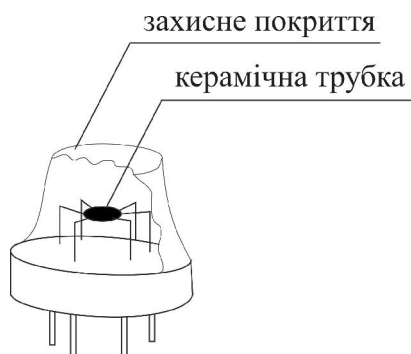
Рисунок 1. – Загальний вигляд напівпровідникового датчика MQ
