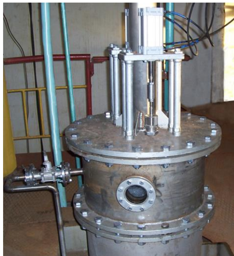
Рис. 2. Фрагмент експериментальної розгінної колони циклічної дії
