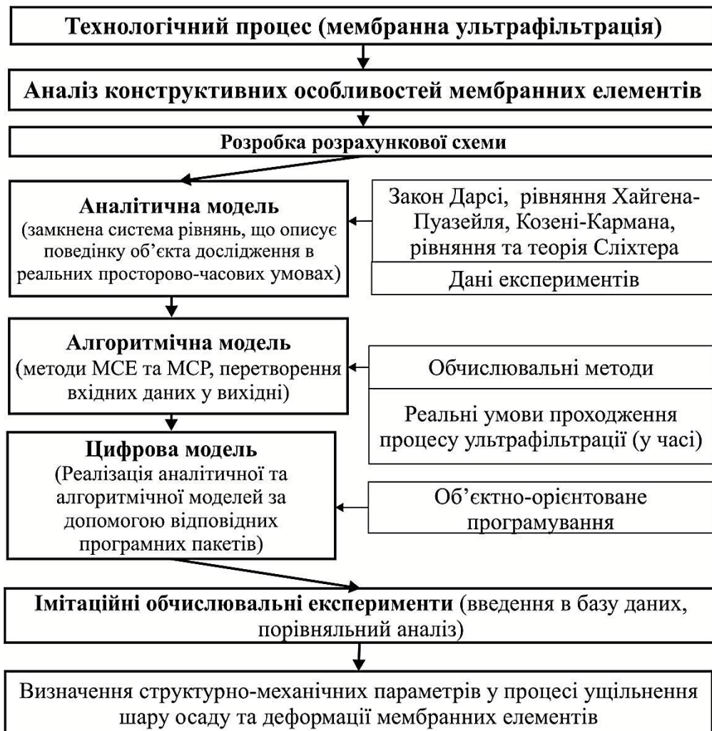
Рис. 3. Схематичне представлення методу дослідження закономірностей мембранного розділення рідких дисперсних систем
