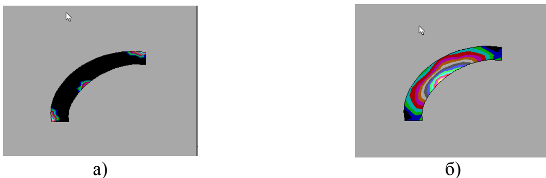
Рис. 7. Ізограма розподілу в точках мембрани по окружній координаті: а) пористості; б) еквівалентних деформацій
