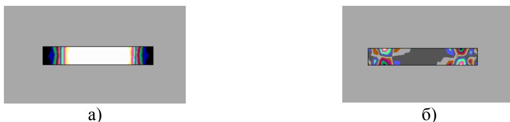
Рис. 6. Ізограма розподілу в точках мембрани по повздовжній координаті: а) пористості; б) еквівалентних деформацій
