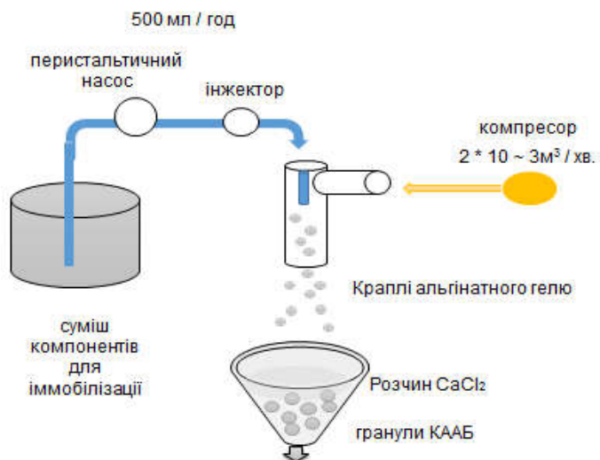
Рисунок 6 - Схема отримання кальцій-альгінатних гранул з кластридіями
