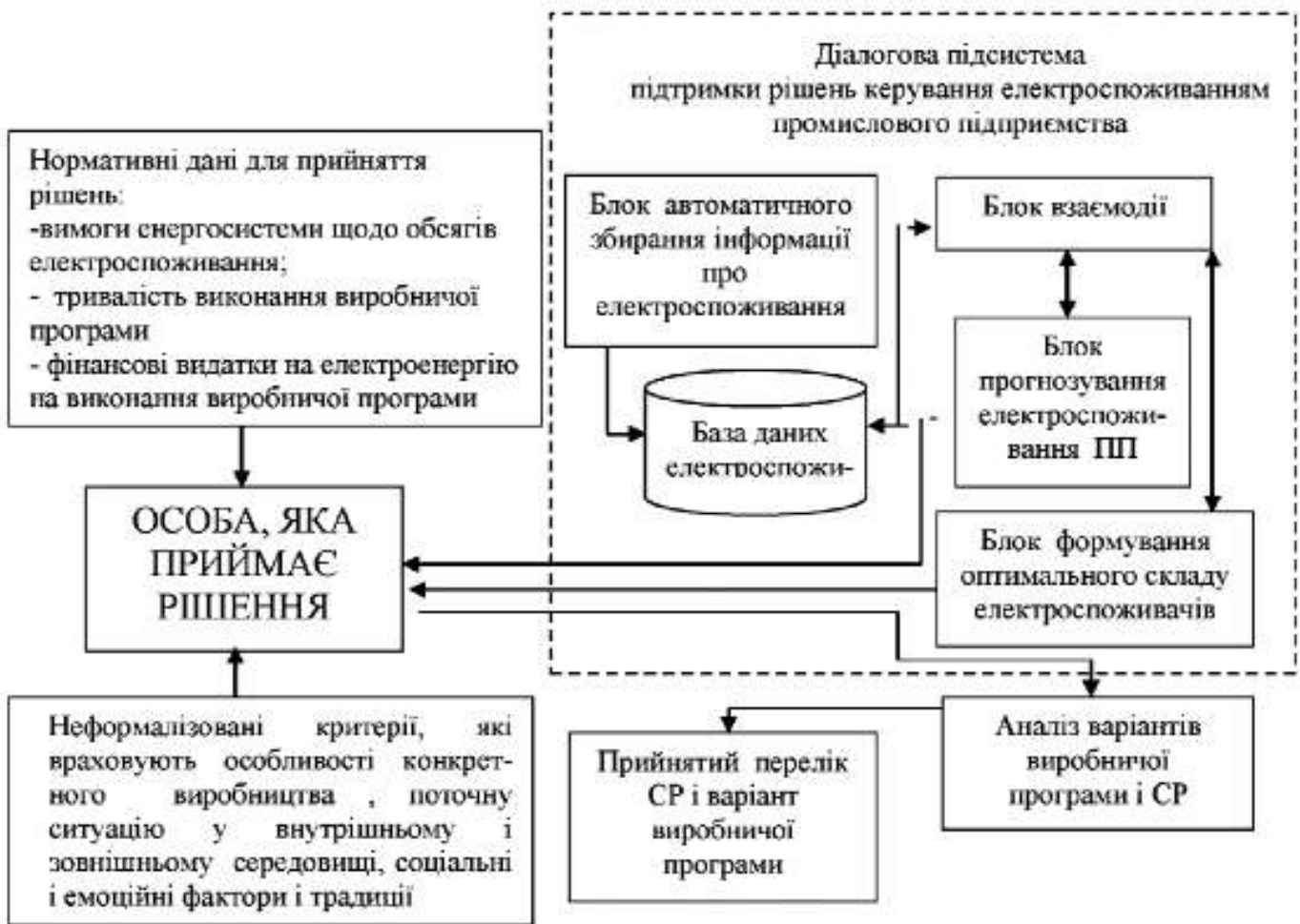
Рис. 4. Блок схема процесу прийняття рішень з керування електроспоживанням з використанням діалогової підсистеми.
