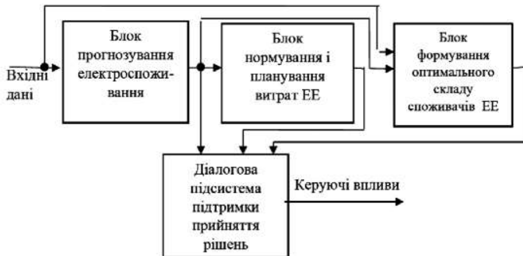
Рис. 3. Структура підсистеми автоматизованого керування електроспоживанням ПП.
