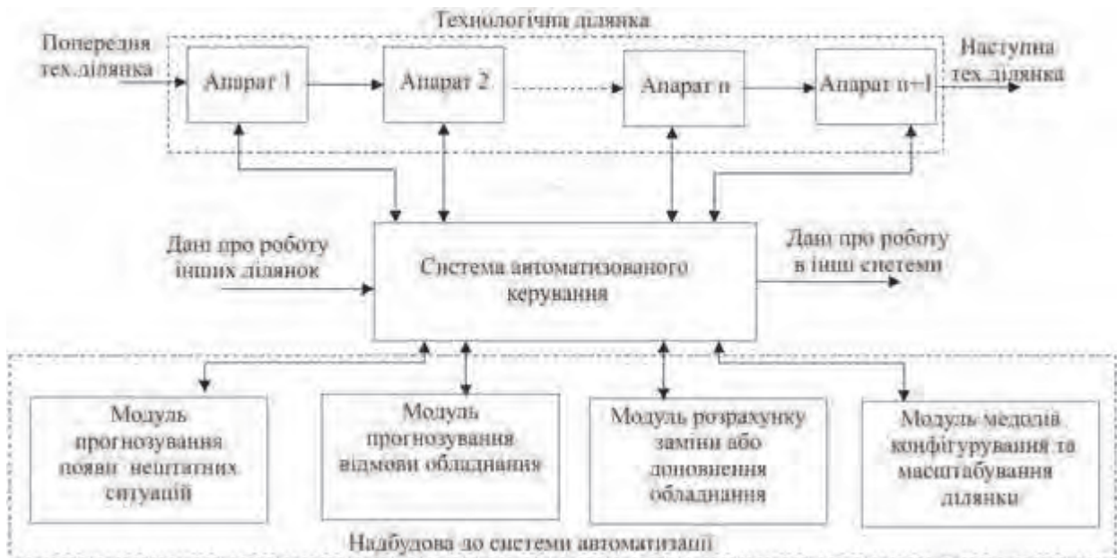
Рис. 2. Автоматизована система для рівня розподіленого керування технологічним процесом
