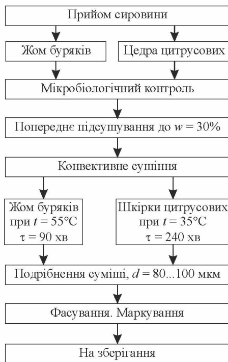
Рис. Принципова технологічна схема отримання композицій харчових волокон із жому цукрових буряків і цедри цитрусових
