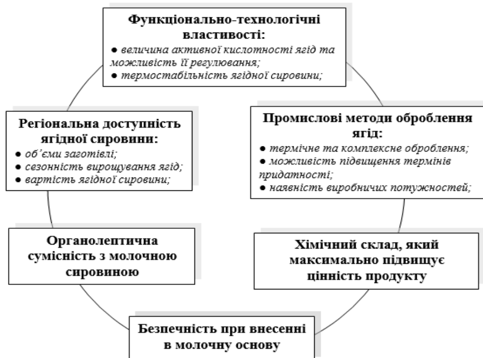
Рис. 1 – Критерії вибору ягідної сировини в якості коагулянту для термокислотного осадження білків молока
